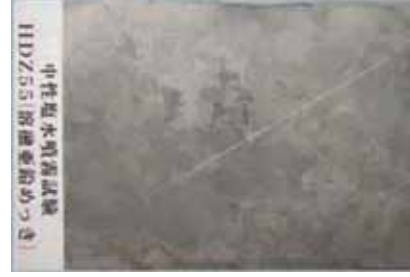
Sıcak-Daldırma Galvanizleme (Çinko 550gr/m 2 )
