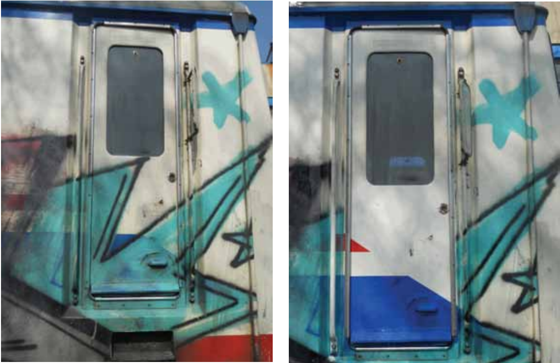
IBIX Sistemi ile trenin orijinal boyasına zarar vermeden graffiti temizliği
